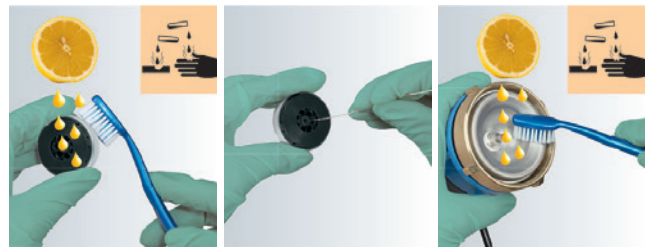
Bild 12: Reinigung von Rotor und Trennkabotte
