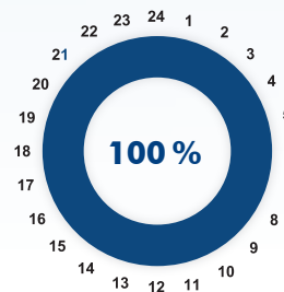
Bild 13: Wird die Zirkulationspumpe im Dauerlauf betrieben, so betragen die Kosten für die Bereitstellungsenergie 100 %.
