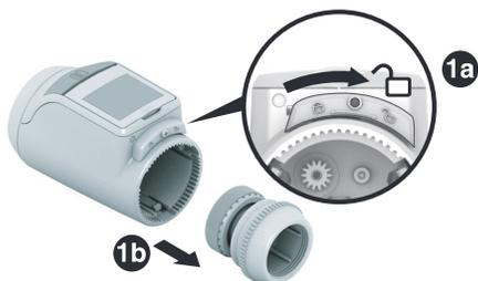
Ventilaufsatz vom Heizkörperregler trennen. Dazu den Schieber in Richtung
