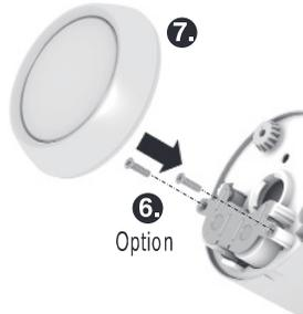
Stellrad abziehen. Dazu an der Kerbe an der Unterseite des Geräts ansetzen.
