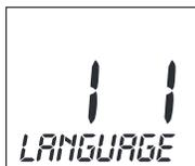
Die rechte Ziffer zeigt die aktuelle Einstellung an. Der Parameter wird zusätzlich noch in Klartext angezeigt. Z. B. steht die Anzeige 1 1 für Parameter 1 (Sprache) mit Einstellung 1 (English).
