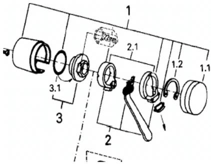
Sie können das weiße Distanzrohr ( im Lieferumfang der Kartusche enthalten oder auch ein 18mm Kupferrohr mit ca.1cm Länge) über den Kartuschenkopf stülpen. Wenn Sie dann durch den Kartuschenkopf einen Dorn oder Nagel stecken, wird die Mutter mit einem 22mm Schlüssel wieder herunter geschraubt. Die Kartusche wird wie mit einem Auszieher aus der Armatur gezogen.
