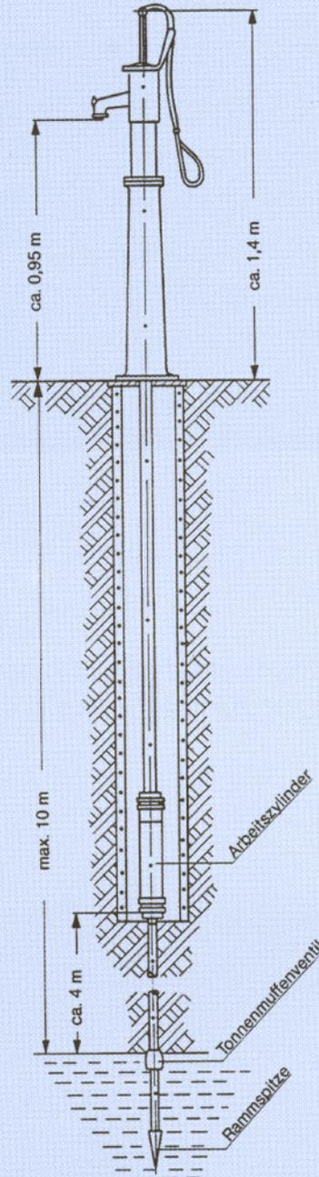
ALLWEILER Saugpumpen bzw. Saug-/ Druckpumpen fördern problemlos gesammeltes Regenwasser aus einer Zisterne sowie Grundwasser aus einem geschlagenen oder gebohrten Brunnen.
