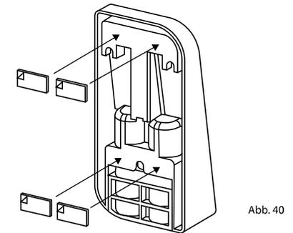
③ Kleben Sie die Tastatur an die gewünschte Position an die Wand (Abb. 41).
