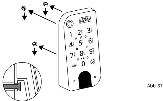
⑤ Setzen Sie das Batteriefach wieder in das Gehäuse ein und schrauben Sie es fest (Abb. 38).
