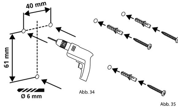
② Fügen Sie die im Lieferumfang enthaltenen Dübel in die Löcher und schrauben Sie die beiliegenden Schrauben ein (Abb. 35).
