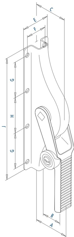
Stabile Tortreibriegel zum Feststellen des Standflügels an zweiflügeligen Stahl- oder Holztoren
