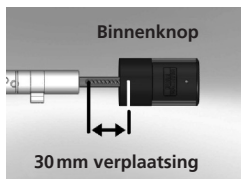
Schematische weergave binnenknop-verplaatsing
