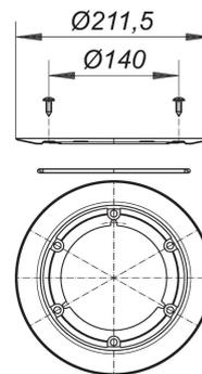
zur Befestigung polymerer Dichtungsbahnen, passend zu den Bodenbläufen Serie 10
